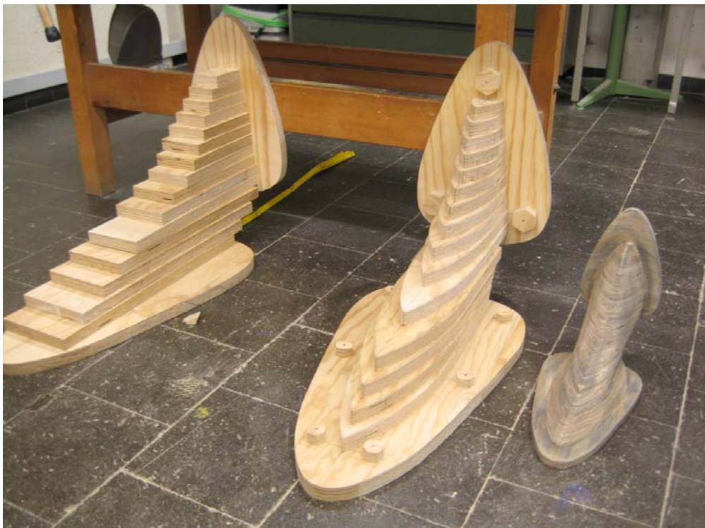
Holzmodell für die Giesserei in Vorbereitung. November 2010
